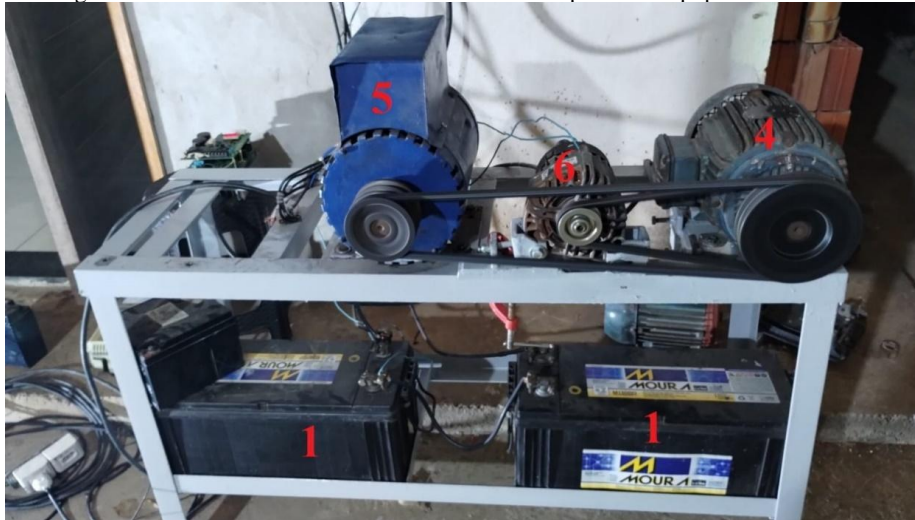
Figura 7 – Bancada de cantoneiras metálicas como suporte aos equipamentos do teste
