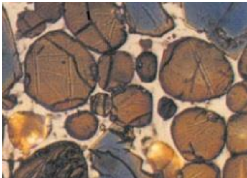
Figura 4. Aspecto microscópico de luz polarizada de reflexão dos cristais de belita (Fonte: Campbell, 1999).
